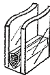
2枚のガラスの間に空気層ができて、断熱性能アップ。
